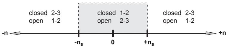
$n$  = Drehzahl/Speed $n_s$  = Eingestellte Schaltdrehzahl / Adjusted switching speed
