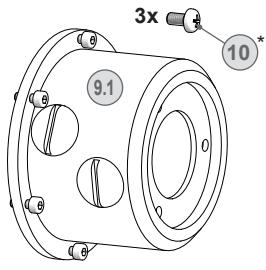
**9.1** Anbauvorrichtung mit Befestigungsschrauben, zum direkten Anbau an den Servoflansch (kundenspezifisch)
